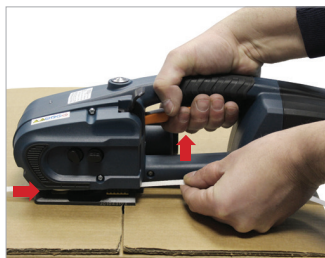
Inserimento della reggetta Insert strap
