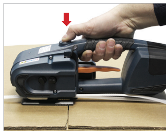
Tensionamento tramite pulsante Tensioning by button
