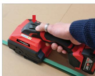
Saldatura e taglio tramite pulsante
